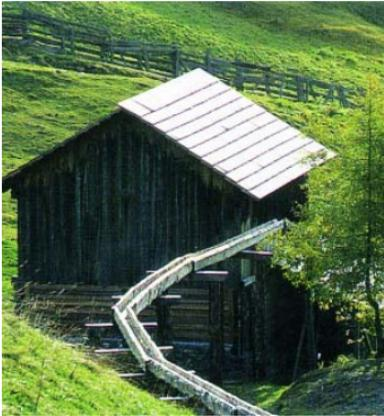
*Die Campiller Mühlen sind Holzbauten aus behauenen Stämmen und mit einem Schindeldach gedeckt. Das Schöpfrad wurde durch Wasser aus einem eigens angelegten Mühlkanal angetrieben. Die Wasserräder befinden sich auf der Traufseite der Mühle. Konstruktiver Holzschutz verhindert die Witterungseinflüsse. Der Durchmesser der Wasserräder beträgt zwischen 2,20 und 3 Meter.*
